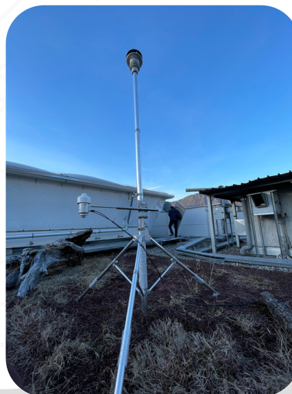
Stativo in alluminio telescopico fino a 3 mt, con sistema di fissaggio con pesi o picchetti
