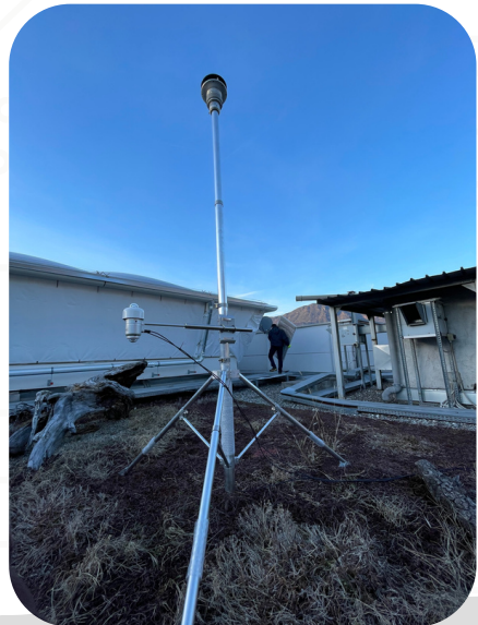
Stativo in alluminio telescopico fino a 3 mt, con sistema di fissaggio con pesi o picchetti
