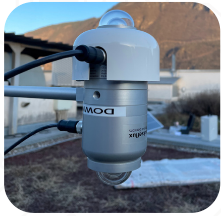
Sistema per la misurazione dell'albedo
